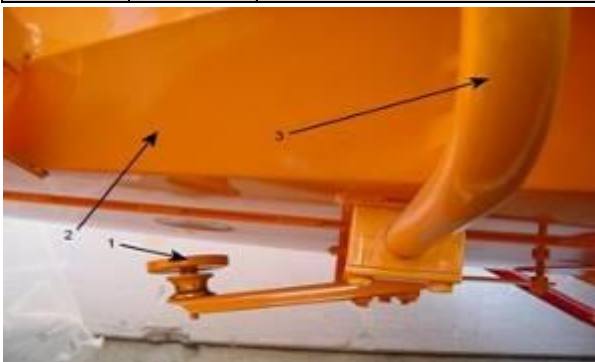
ILLUSTRATION: POSITION DE L'AIMANT LORSQUE LA SÉCURITÉ EST ENCLENCHÉE
