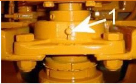
ILLUSTRATION: GRAISSAGE DE L'AXE PRINCIPAL A L'AVANT
