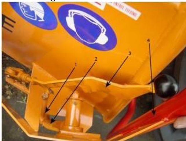
ILLUSTRATION : DÉVERROUILLAGE DE LA SÉCURITÉ
