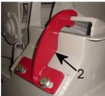
ILLUSTRATION: VERROU DE BLOCAGE SUR LE DISQUE MUNI
