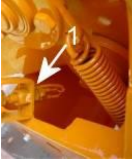
ILLUSTRATION : L'INTERRUPTEUR DE CONTRÔLE DU CAPOT SUPÉRIEUR (VOIR N°. 1)
