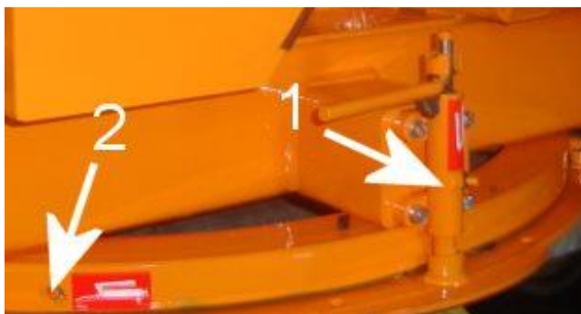
ILLUSTRATION: GRAISSAGE DE LA TOURELLE (N°2) ET DU VERROU (N°1)
