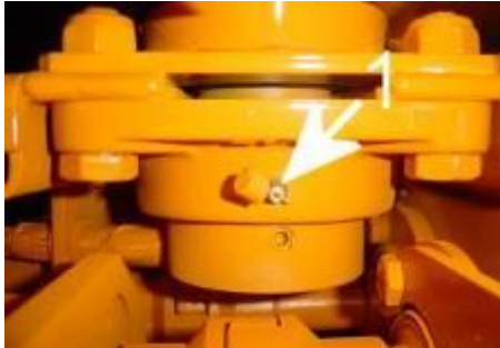
ILLUSTRATION: GRAISSAGE DE L'AXE PRINCIPAL A L'ARRIERE
